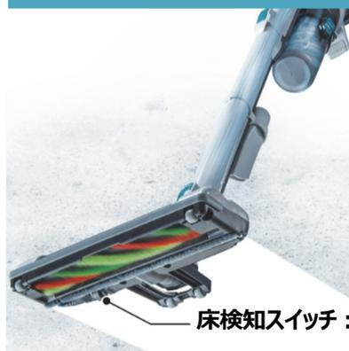
床検知スイッチ：床に接地すると回転ブラシが駆動し、浮かせると回転ブラシが停止
